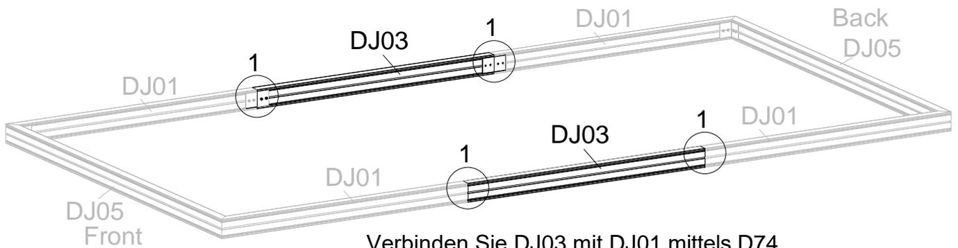
Verbinden Sie DJ03 mit DJ01 mittels D74 und ziehen Sie sie dann mit S14 & M03 fest.
