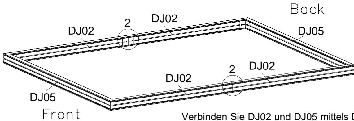
Verbinden Sie DJ02 und DJ05 mittels D73 und ziehen Sie sie mit S14 & M03 fest.
