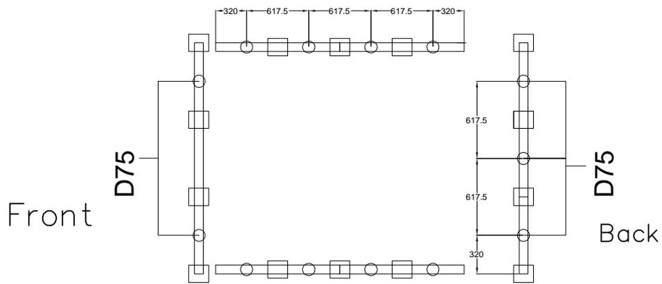
Dies zeigt ein Layout für die Positionen von D75 und D76, wo es in der Mitte des PC-Panels für jeden Abschnitt platziert wird.
