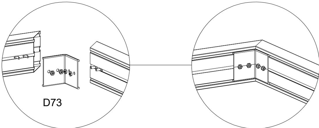
Verbinden Sie DJ01 mittels D74 und ziehen Sie sie mit S14 & M03 fest.
