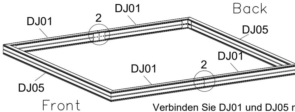
Verbinden Sie DJ01 und DJ05 mittels D73 und ziehen Sie sie dann mit S14 & M03 fest.
