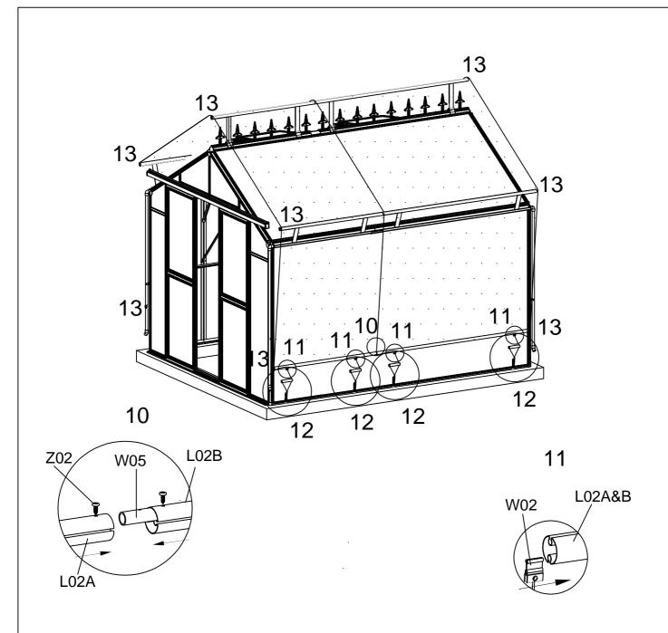
Stecken Sie das Teil W02 in die L02A&B an beiden Enden der Sonnenschutzstange. Bringen Sie dann den Seil- und Federspanner W03 an, um das Schattentuch fest zu fixieren.
