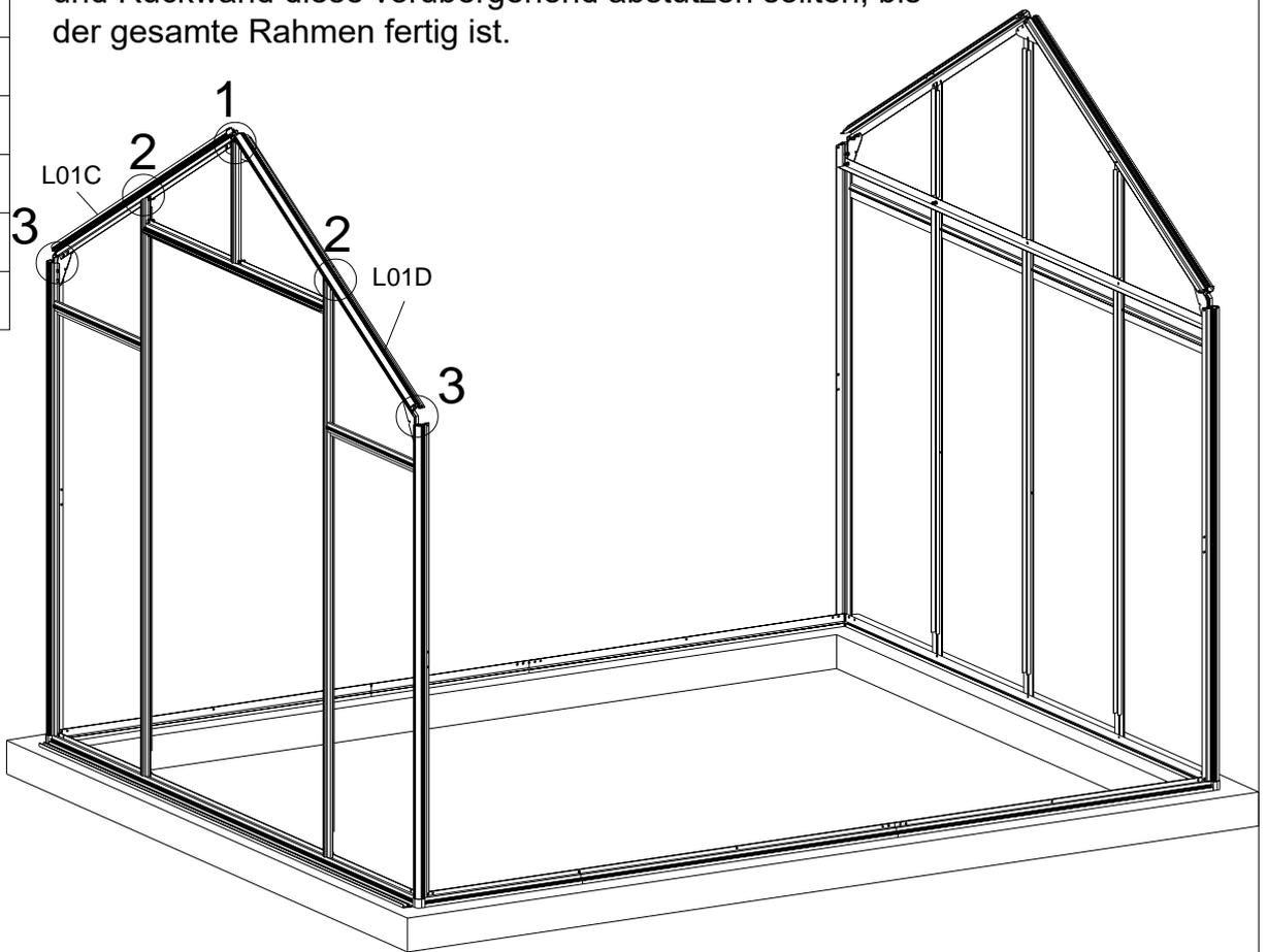
Schieben Sie den Verbinder A26 in L01C und L01D, um sie zu verbinden. Verwenden Sie Teil D17, um alles mit den mitgelieferten Schrauben und Muttern zu befestigen.
