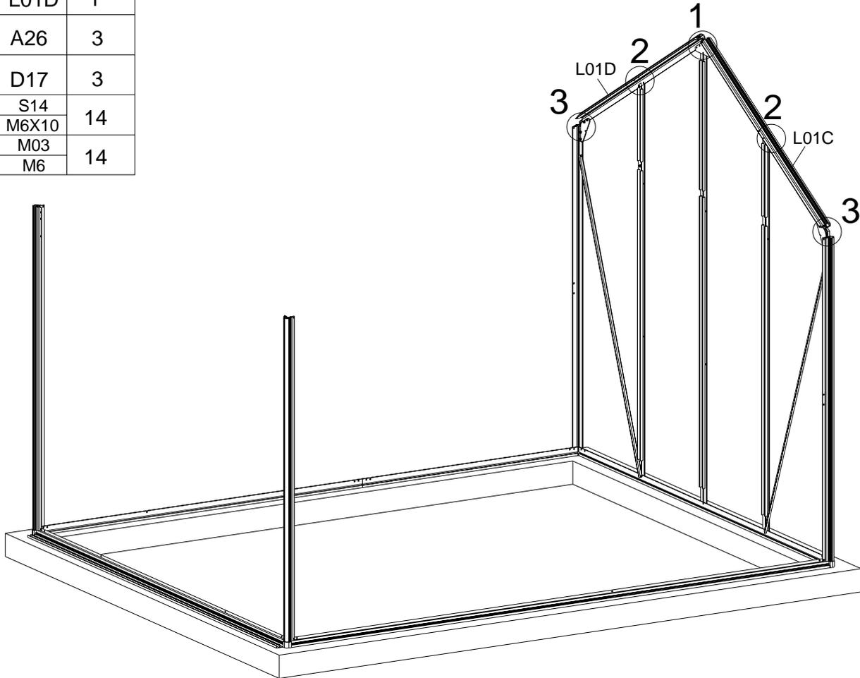
**1** Schieben Sie den Verbinder A26 in L01C und L01D, um sie zu verbinden. Verwenden Sie Teil D17, um alles mit den mitgelieferten Schrauben und Muttern zu befestigen.
