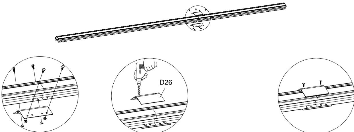
Montieren Sie L06A und L06 mit Hilfe der D27-Profile zusammen mit den Schrauben und Muttern.
