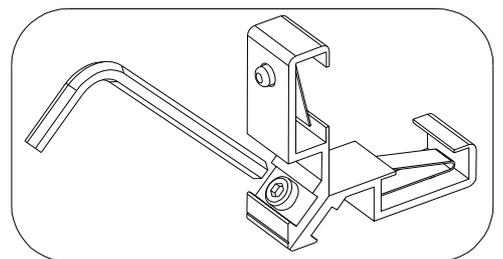
Drücken Sie den Knopf am Verbinder A27, bevor Sie ihn in das Ende des Rahmenprofils einführen.
