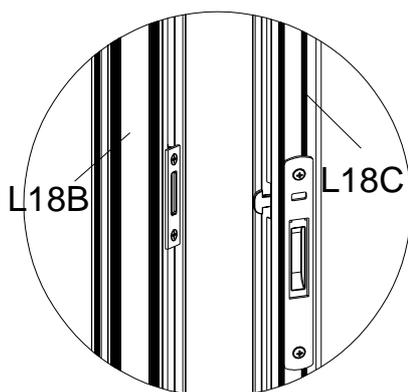
Schieben Sie L16A in L17A und L18D. Schieben Sie L16B in L18A und L18B. Montieren Sie dann die Türrahmen mit dem Verbinder A28, wie in den Skizzen unten gezeigt.
