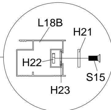
Schrauben Sie S15 in die Löcher von H21, H23 und H22 und schieben Sie sie in den Kanal von L18B. Stellen Sie die Position so ein, dass sie mit der Verriegelung auf L18C übereinstimmt und ziehen Sie sie fest.
