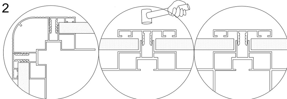
Schieben Sie alle Y6-Platten an ihren Platz. Die Oberseite der Platten sollte hinter das Rinnenprofil geschoben und dann gegen das Basisprofil gedrückt werden, wie in den Detailzeichnungen gezeigt. Die Platten sollten durch die Abdeckleisten L11A, L11C und L12A locker gehalten werden. Klopfen Sie die Abdeckleisten mit dem Gummihammer fest, aber sanft an ihren Platz.
