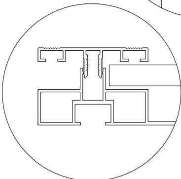
Klopfen Sie alle Abdeckprofile mit einem Gummihammer in die Nuten jedes Rahmenprofils, wie in den Detailzeichnungen dargestellt.
