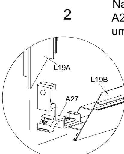
Nach der Montage des Verbinders A27, nutzen Sie das Loch im Profil um den Verbinder festzuziehen.
