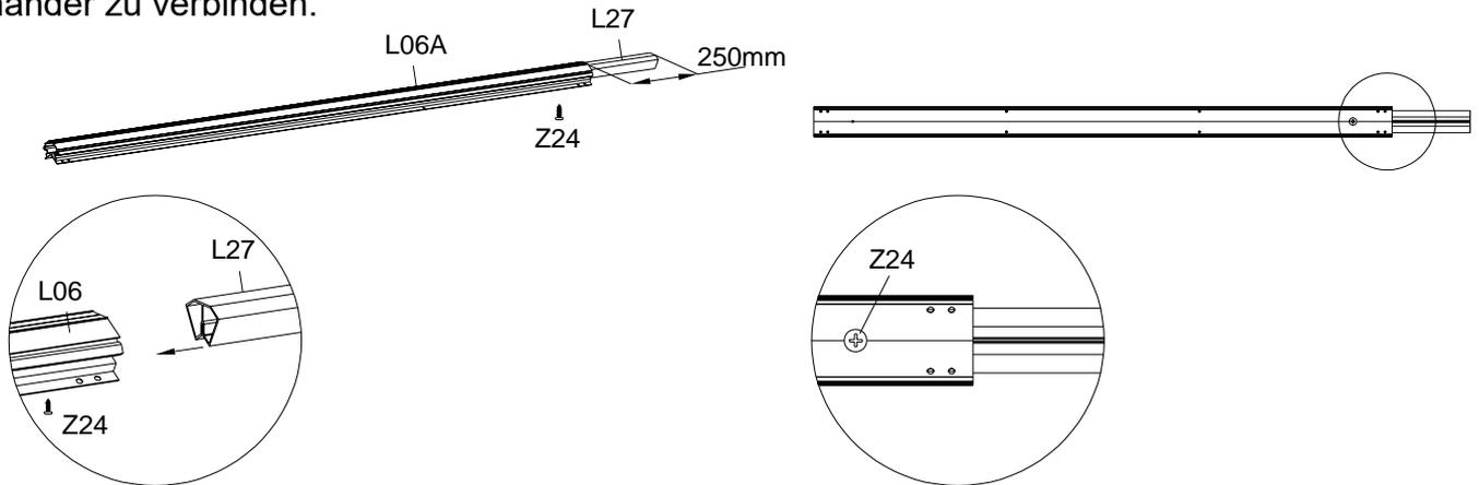
Führen Sie die Hälfte von L27 in L06 ein, so dass 250mm von L27 übrig bleiben. Sichern Sie L27 und L06 mit Z24.
