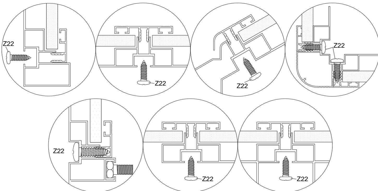
Befestigen Sie jedes Abdeckprofil fest mit Schrauben Z22, wie in den Detailzeichnungen dargestellt.
