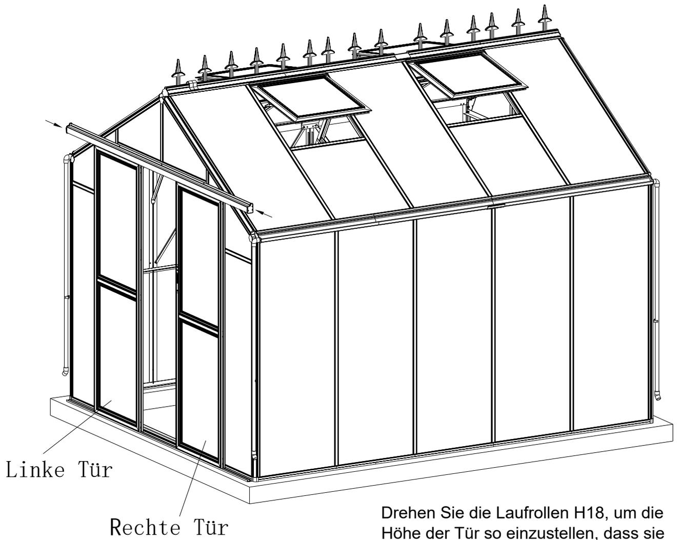
Drehen Sie die Laufrollen H18, um die Höhe der Tür so einzustellen, dass sie nicht an der unteren Schiene klemmt oder scheuert.
