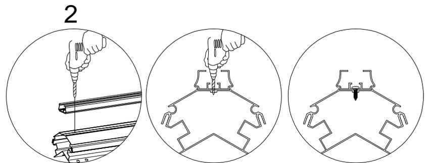
Schneiden Sie 56mm von 2 Profilen L26A (bei D26) ab. Montieren Sie dann alle L26A auf L06A & L06 und achten Sie darauf, dass L26A mit den Längen von L06A & L06 übereinstimmt (siehe Abb. oben).
