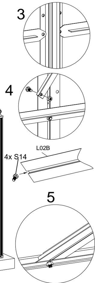
Montieren Sie L02B und stecken Sie 3 zusätzliche Schrauben in das Profil ein, die später zur Befestigung der Verstärkung benötigt werden.
