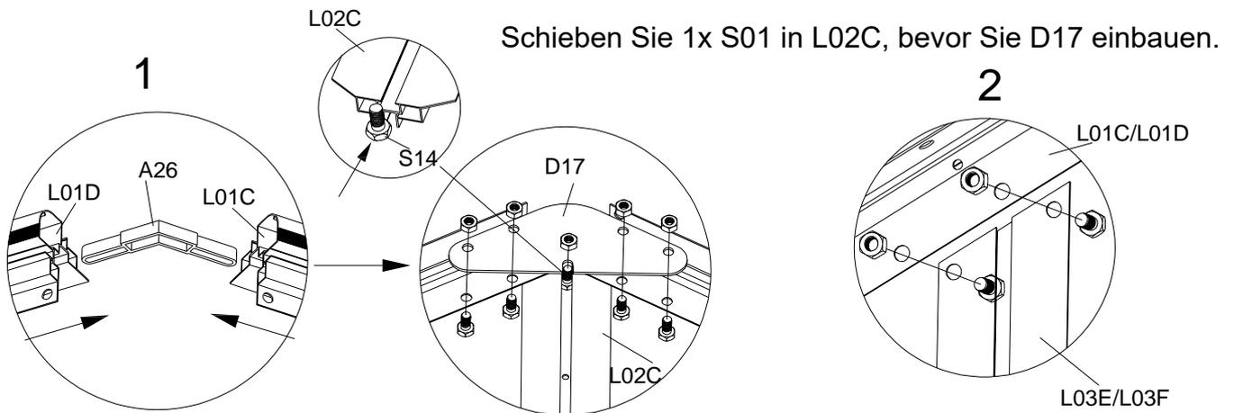
3 Verbinden Sie L01B mit L01D und L01A mit L01C mit Hilfe von Verbinder A26 und Teil D17 und ziehen Sie sie mit den mitgelieferten Schrauben und Muttern fest.
