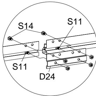
Befestigen Sie L08A an L08B mit D24. Schrauben Sie ihn mit S11 und S14 fest.
