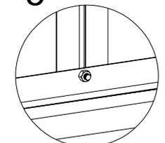
Montieren Sie L02A und führe 2 zusätzliche Schrauben lose in das Profil ein, die später zur Befestigung der Verstärkung benötigt werden.
