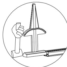
Schieben Sie B01, B02 und B03 in der richtigen Reihenfolge in jede Seite von L26A. Verwenden Sie ggf. einen Gummihammer.
