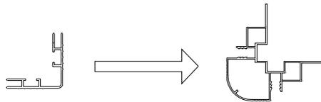
2. Ein weiterer großer Vorteil ist die Art und Weise, wie die Glas- und Polycarbonatplatten in den Gewächshausrahmen eingelegt und mit Abdeckstreifen abgedeckt werden. Dies ist eine viel schönere und stabilere Ausführung und die Platten sind im Rahmen fixiert.
