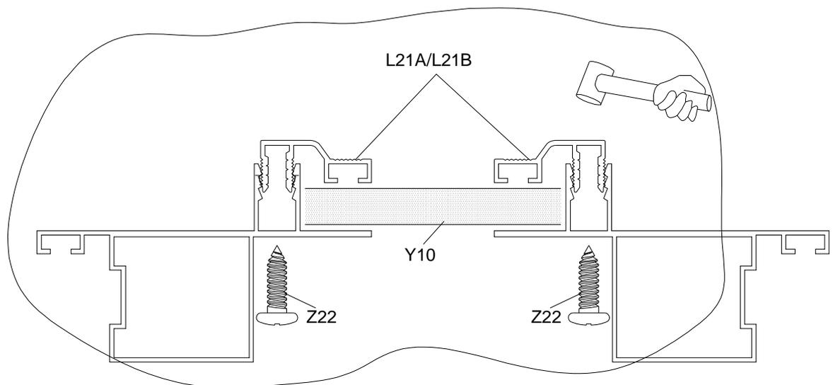
Die PC-/Glasplatte Y10 wird von den Abdeckleiste, den Profilen L121 A und B, locker gehalten (bei Glas in die Profile Gummi einlegen!). Setzen Sie die Abdeckleiste mit dem Gummihammer vorsichtig in die richtige Position. Befestigen Sie dann die Abdeckleiste mit den Schrauben Z22.
