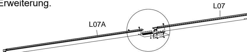
L07 & L07A über D25 & D27 montieren und mit Schrauben und Muttern festziehen (siehe Abb. unten).
