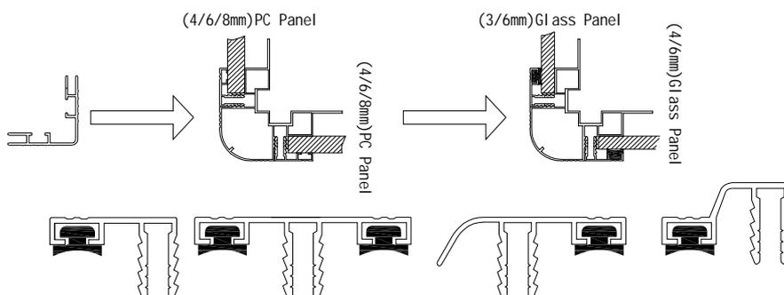
\* Wenn das Gewächshaus mit Glaspaneelen ausgestattet ist, sollte jede Abdeckleiste mit dem mitgelieferten Gummi versehen werden. Schieben Sie ihn einfach in die Abdeckleisten.
