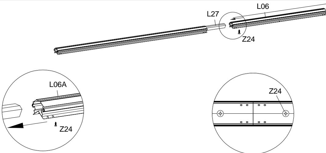
Stecken Sie das andere Ende von L27 in L06A und prüfen Sie, ob die Verbindung richtig funktioniert. Sichern Sie sie dann mit Z24.
