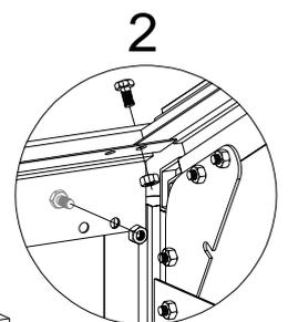
\* Bevor Sie das L22C montieren und die Schrauben und Muttern festziehen, drücken Sie von unten gegen den Nocken, um zu prüfen, ob der gesamte Nocken gerade ist.
