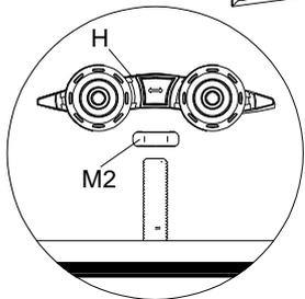
Schieben Sie 2xS02 in L18D im Abstand von 100mm von jeder Kante. Befestigen Sie S12 mit M06-Schrauben und drehen Sie die Räder, um eine freie Bewegung zu gewährleisten.
