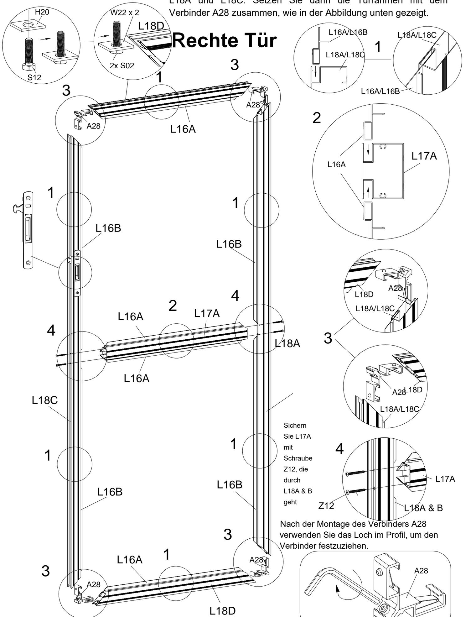
Sichern Sie L17A mit Schraube Z12, die durch L18A & B geht
