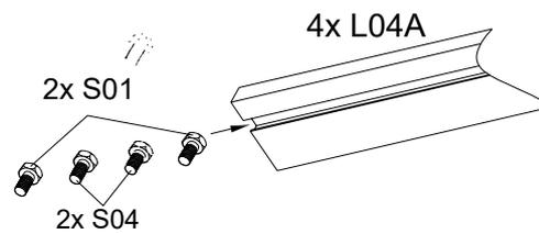
Schieben Sie 2 zusätzliche Bolzen in das Profil L04A, um Teil A03 zu befestigen.
