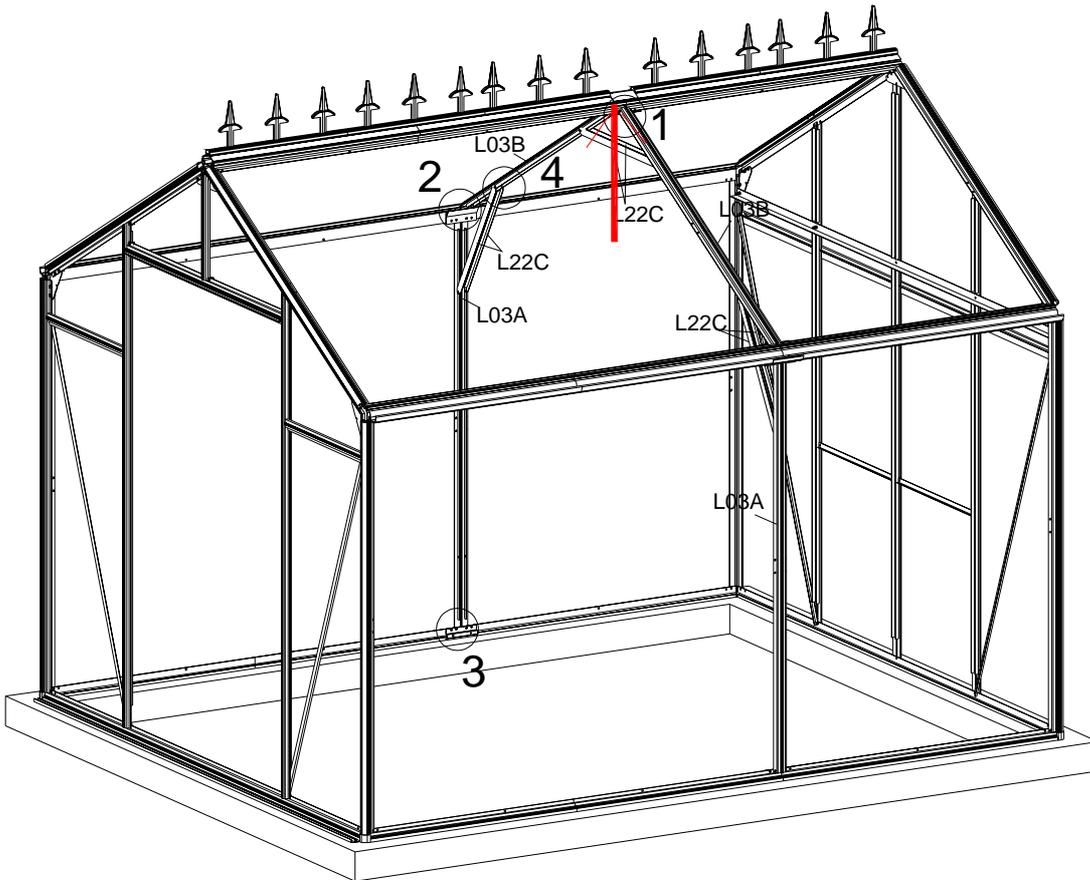
\* Vergewissern Sie sich auch, dass die Dachrinnenprofile von Ende zu Ende gerade sind, bevor Sie die L22C's an die Seiten schrauben. Sie können diese auch abschrauben, um später Anpassungen vorzunehmen.
