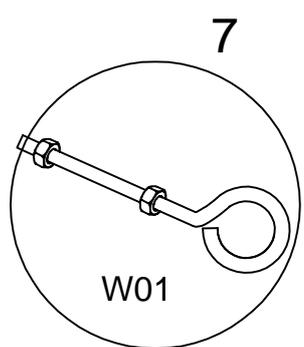
Platzieren Sie ein W01 im Abstand von 175 mm vom Ende jedes Gewächshausbodens. Bohren Sie 16 Löcher mit einem Durchmesser von 6 mm durch W01 in die Bodenprofile. (siehe Abb. oben)
